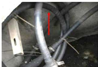
Fig. 6. Radio de Curvatura inadecuado. [5]
