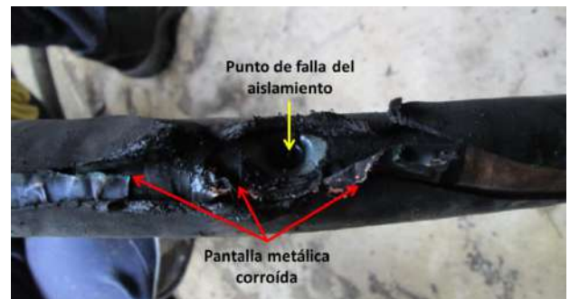
Fig. 1. Falla por ingreso de humedad en cable
