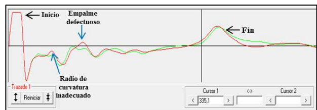
Fig. 3. Gráfica prueba de Reflectometría. [5]
